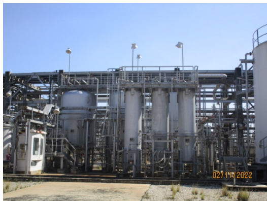
รูปที่ 21 Hg Treating Package สำหรับบำบัด น้ำปนเปื้อนปรอทจากถังเก็บฟลูออรีนจ่คอนเดนเสท
